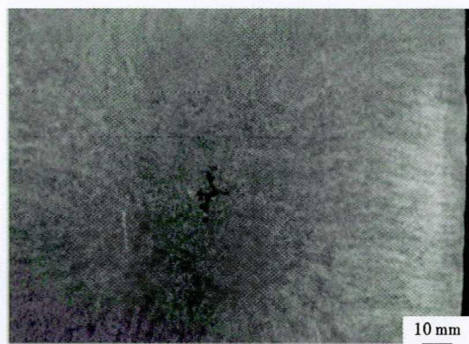
图 2 1215 钢铸坯低倍中心疏松
