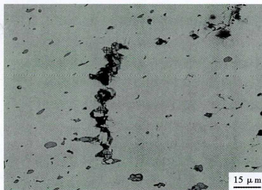
图 3 1215 钢轧材 MnS 夹杂物
